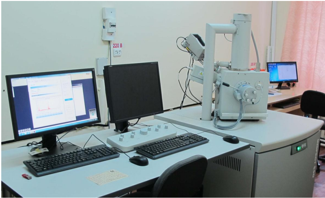
Растровый электронный микроскоп FEI Inspect S50 с приставкой энергодисперсионного анализа EDAX
